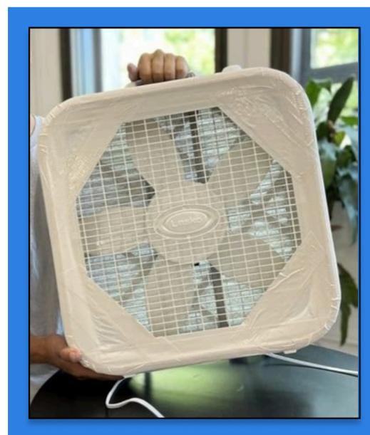
6. Ajouter plus de ruban au besoin pour fermer toutes les ouvertures autour des arêtes et dans les coins.
