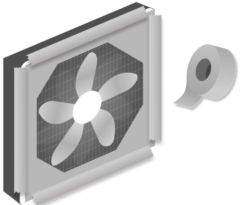
5. 用胶带粘住风扇前方的四角。从外缘量出 5.3 英寸。
