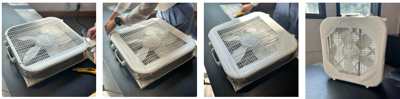
1x1自製空氣清淨器機組之膠帶擋風罩逐步製作說明
